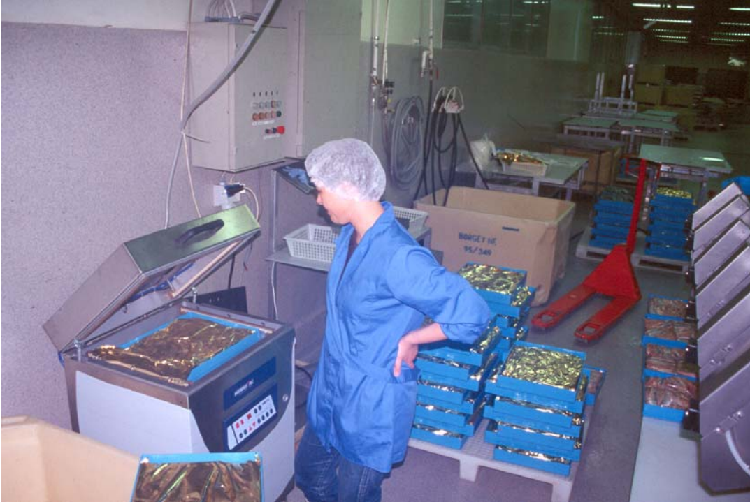
Mynd 1. Lofttæming á pakkningum með síldarflökum fyrir frystingu.
