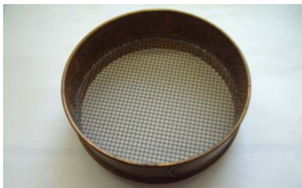
Mynd 7. Sigt notað til síunar á fiskmassa úr frárennslisvatni.
