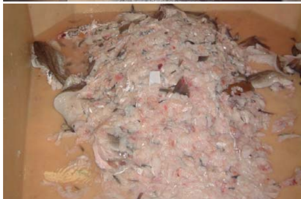
Mynd 3. Tromlusigtun úr frárennslisvatni frá bol-fiskvinnslu og safnaður fiskmassi
