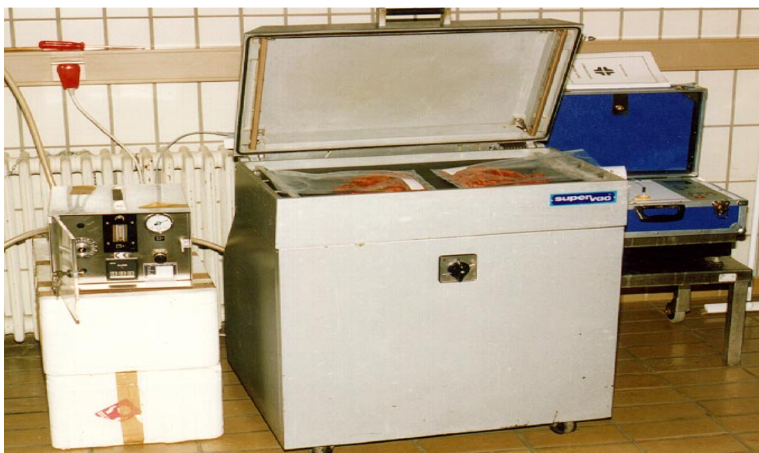
Mynd 1. Uppsetning tækjabúnaðar sem notaður var við pökkun. Mixer til að blanda koldíoxíð og köfnunarefni, pökkunarvél og gasmælir til þess að mæla samsetningu gasblöndunnar.
