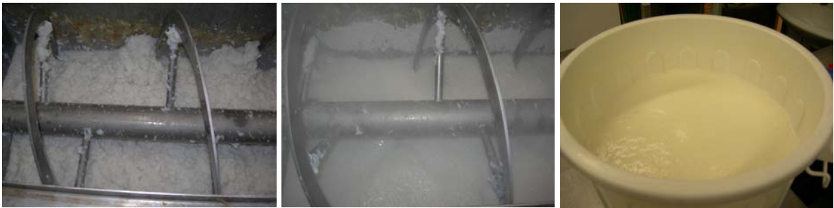
Mynd 2. Framleiðsla á hydrolisati úr isolati; isolat sett í blöndunartank (1), isolat verður að einsleitum vökva við hitun (2), tilbúið hydroliserað isolat (3).
