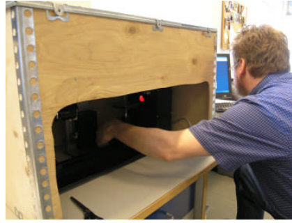
Mynd 3 CAM 200 snertihornsmælir frá KSV Instruments. Einnig er sýnt hvernig tækinu var komið fyrir í kassa til að draga úr truflunum frá utanaðkomandi ljósi.
