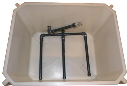
Mynd 3: Ker útbúið með rörum til að hringrásu kælivatni
