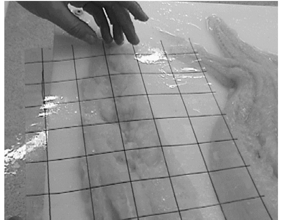
Mynd 3.2 Rúðustrikað plastspjald sem notað var til að meta los, blóðbletti og holdroðabletti.
