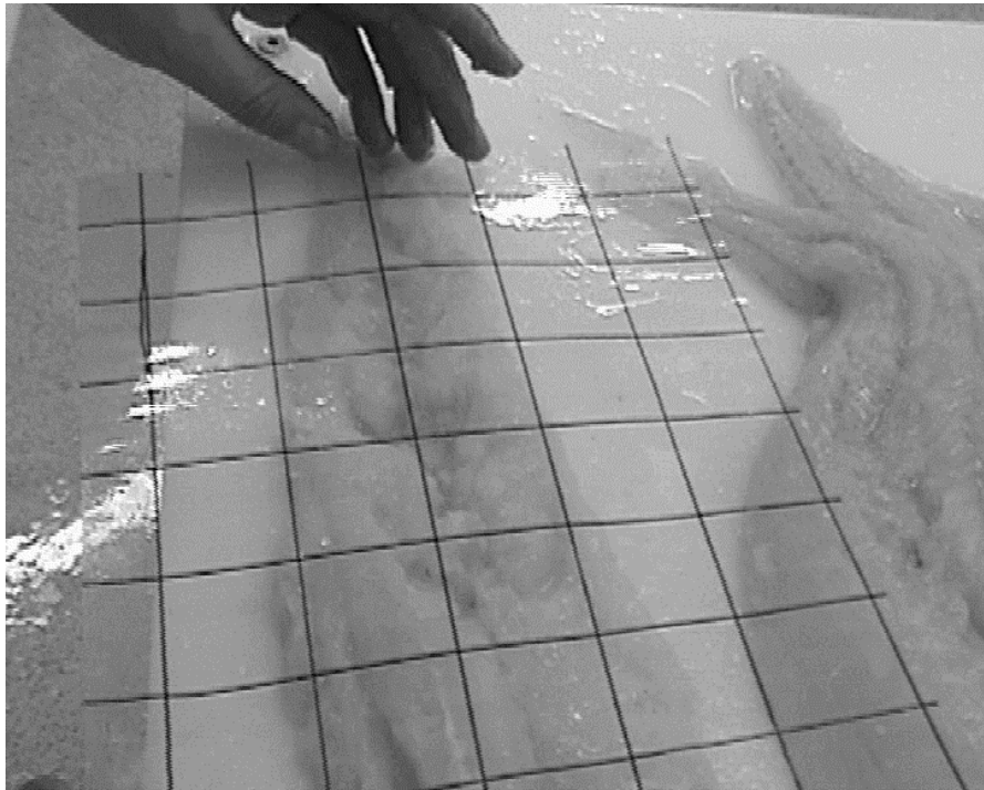
Mynd 3.2 Rúðustrikað plastspjald sem notað var til að meta los, blóðbletti og holdroðabletti.
