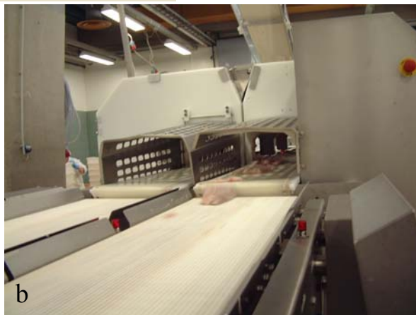
Mynd 11. (a) Burðargrind (prófílar) er opin í þann enda sem snýr að gólfi (b) Slétt belti sem safnar í sig raka og lárétt hlíf sem safnar raka og óhreinindum
