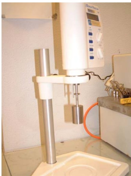
Mynd 2. Bohlin Visco 88. Seigjumælir notaður í verkefninu.
