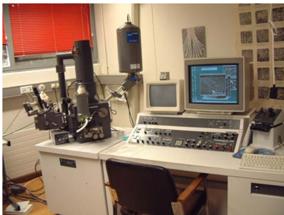
Mynd 7. Rafeindasmásjá (Scanning Electronic Microscopy) staðsett á Iðntæknistofnun Íslands
