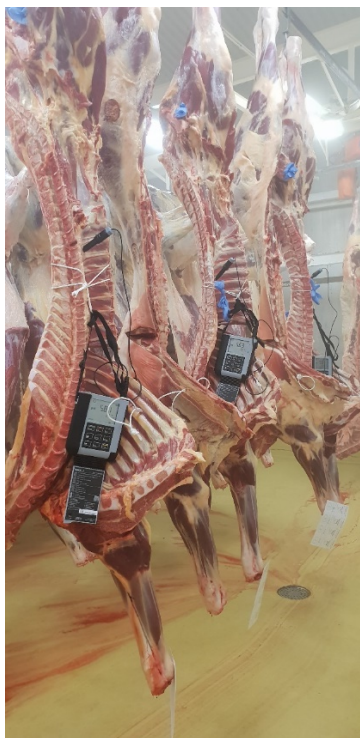
Mynd 4. Knick pH mælir. Stungið í hangandi skrokk á kæli innan frá milli næst aftasta og aftasta hryggjaliðar/rifs, inn í miðjan hryggvöðva.
