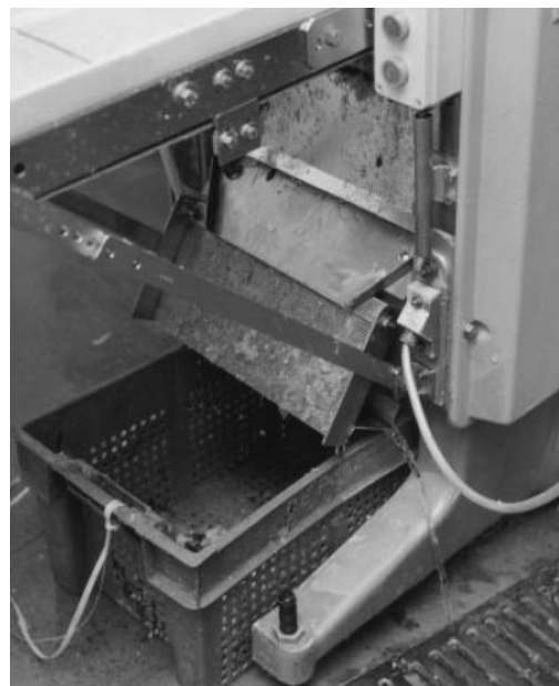
Mynd 3. Söfnunarkarfa með vatnshlíf sem minnkar rennsli á roð (AMEC, 1999).
