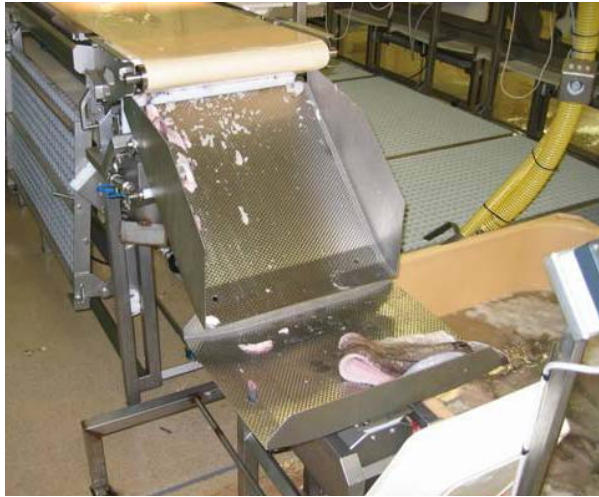
Mynd 2. Endinn á forsnyrtibandi, vogin er þar sem flakið er. Voginn vigtar 5-6 flök í hverjum skammti og hellir flökunum í kerlið.
