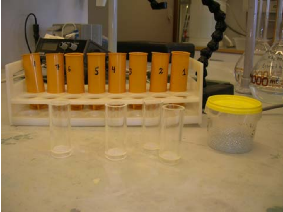
Mynd 16 – Sýnaglös o.fl. fyrir vatnsheldnimælingar.
